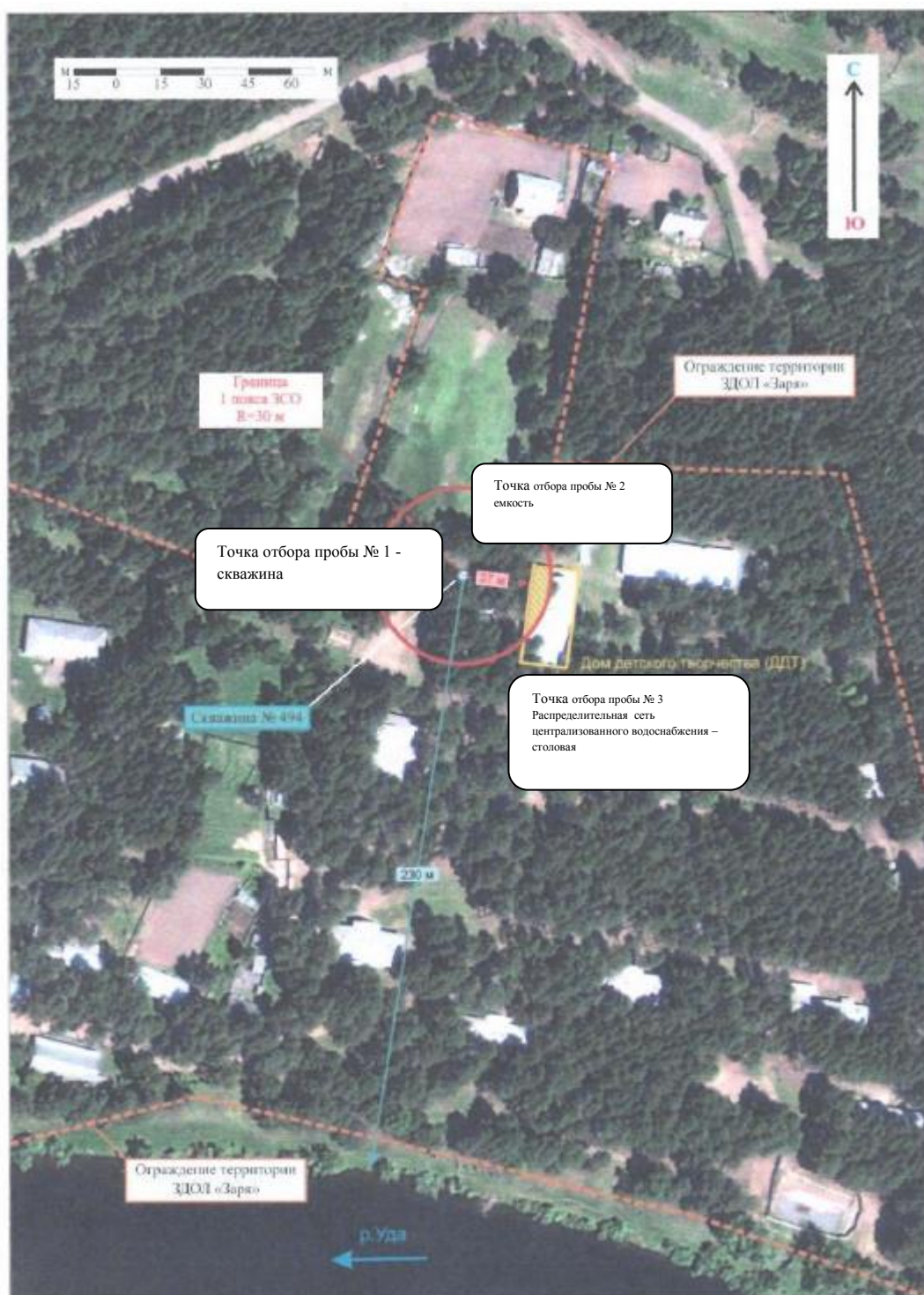
Рис. 1.3. Ситуационный план участка размещения водозабора со скважиной № 494 и проектируемой границей первого пояса ЗСО
